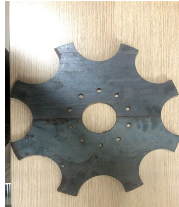
Disk machine with R = 250 mm (Dallev, 2013)
