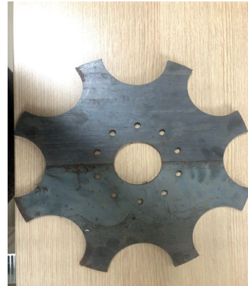
Disk machine with R = 250 mm (Dallev, 2013)
