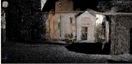
Figure 8 The LASER Scanning Surveying of the Tempio di San Giovanni al Sepolcro, in Brindisi, Italy
